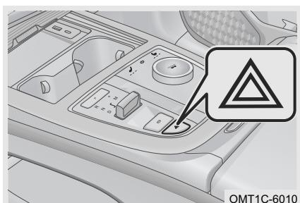
Presione el interruptor de la luz de peligro para encender y presíónelo nuevamente para apagar.
