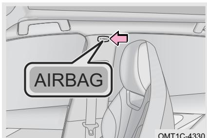
Cuando el vehículo está sujeto a colisión lateral y se cumplen las condiciones de despliegue, el airbag de cortina puede proteger la cabeza de los pasajeros que se sientan en el asiento delantero y en el asiento exterior trasero del lado afectado, reduciendo el riesgo de lesiones.
