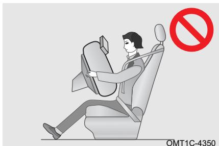
Mantenga siempre limpia la tura de inflado de airbag. Está prohibido colocar cualquier cosa (teléfono, etc.) entre el ocupante y el airbag. Está prohibido fijar o colocar cualquier objeto sobre o cerca de la cubierta de airbag. Si hay un objeto entre el ocupante y el airbag, es posible que el airbag no se despliegue de acuerdo con la ruta de diseño, o el airbag puede empujar objetos al cuerpo del ocupante, causando lesiones graves o incluso la muerte.
