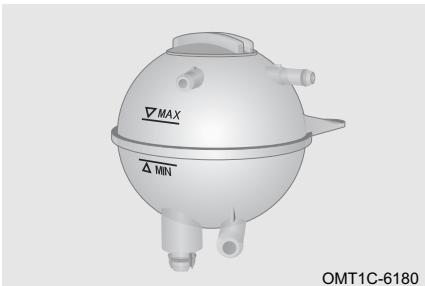
5. Si no hay fugas evidentes, abra el depósito del líquido refrigerante y compruebe si el nivel de refrigerante en el depósito es bajo. Si está en o debajo de "MIN", agregue el refrigerante al nivel que está entre "MIN" y "MAX". Utilice únicamente el tipo de refrigerante recomendado.
