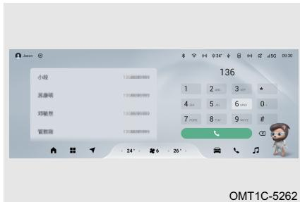
Gire el interruptor de ARRANQUE Y PARADA DEL MOTOR al modo ON, y conecte el Bluetooth del teléfono móvil y el Bluetooth de la unidad principal en el sistema de la unidad principal. Puede soportar funciones como hacer llamadas Bluetooth, descargar contactos y navegar por el historial de llamadas después de que la conexión sea exitosa.
