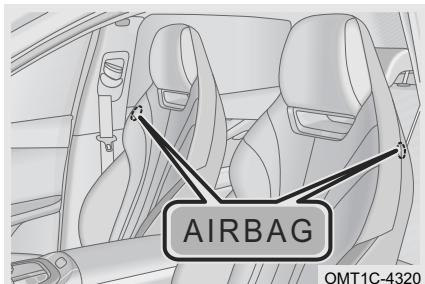
Cuando el vehículo está sujeto a una colisión lateral y se cumplen con las condiciones de despliegue, el airbag del asiento del lado impactado se despliega. Además del cinturón de seguridad, el airbag lateral del asiento es un tipo de aparato que puede proporcionar más protección para el conductor y el pasajero delantero.
