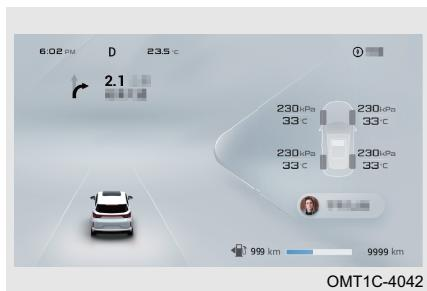
Gire el interruptor de ARRANQUE Y PARADA DEL MOTOR al modo ON, presione "ESP" en el volante para cambiar a la pantalla de visualización de la presión de neumáticos.
