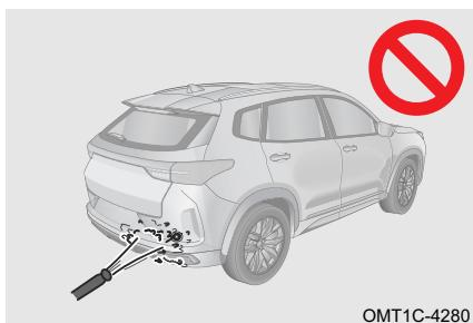
El flujo de agua a alta presión, como pistolas de agua o grandes fuerzas externas, puede dañar los sensores de radar. No apriete ni golpee el sensor de radar, de lo contrario, podría causar funcionamiento anormal.
