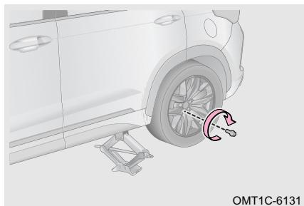
Primero enrosque los 5 pernos de ruedas con la mano hacia la derecha cuando instale los pernos de las ruedas, luego apriete previamente todos los pernos con la llave de ruedas.
