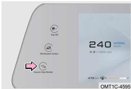
La velocidad del vehículo es menor de 15 km/h (D); Después de recibir la señal de distancia del obstáculo de radar de estacionamiento delantero, accede al monitor de vista panorámica (si está equipado).
