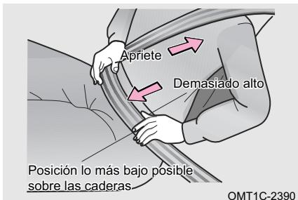
El cinturón de seguridad se bloqueará cuando se extraiga rápidamente, pero no se bloqueará cuando lo saque lentamente. Coloque el cinturón de regazo tan bajo como sea posible en las caderas, no en las cinturas, luego ajústelo a un ajuste ceñido tirando del cinturón de hombros hacia arriba.
