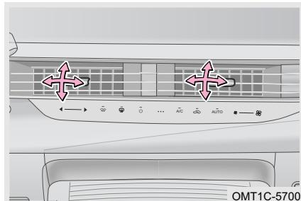
Mueva la palanca de ajuste de la salida central hacia arriba y hacia abajo, hacia la izquierda y hacia la derecha con la mano, para ajustar la dirección del flujo de aire.
