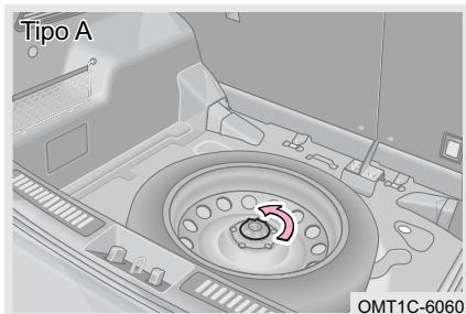
Abra el portón trasero, levante la alfombra del maletero y saque la caja de almacenamiento y la bolsa de herramientas. Gire el perno de fijación del neumático de repuesto en sentido contrario para retirarlo y luego extraiga el neumático de repuesto.
