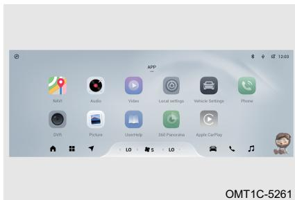
La pantalla de la aplicación APP incluye navegación, radio, grabadora de conducción, ajuste local, ajuste del vehículo, manual electrónico, teléfono y mi centro, etc.
