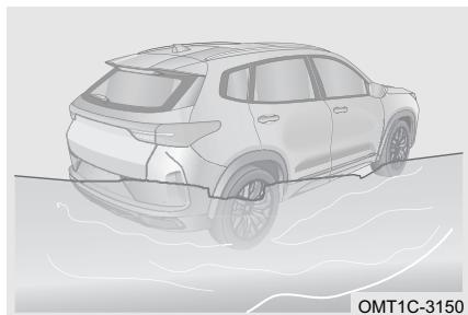
El vehículo se podría ver gravemente dañado al conducir en una carretera que se ha inundado después de una lluvia intensa. Si es inevitable conducir sobre agua, revise la profundidad de agua y conduzca lentamente y cuidadosamente.
