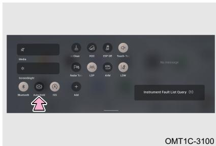
Condiciones de activación de la función de retención automática: El motor se arranca, la puerta del lado del conductor está cerrada correctamente y el cinturón de seguridad del lado del conductor está abrochado.
