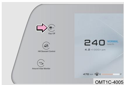
Cuando el interruptor ESP OFF se pulsa, el sistema electrónico de control de estabilidad de la carrocería se apaga; Cuando se vuelve a pulsar el interruptor ESP OFF, se activa el sistema electrónico de control de estabilidad de la carrocería.
