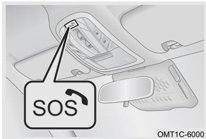
ECALL es un tipo de función de llamada de emergencia. Cuando el vehículo está involucrado en un cierto nivel de impacto (airbag inflado) o cuando el conductor o el pasajero se encuentra en una emergencia y se requiere rescate, la información de emergencia puede ser enviada al centro de servicio operando el botón manualmente, entonces el centro rastreará la ubicación del vehículo y ofrecerá rescate inmediatamente de acuerdo con la información recibida.
