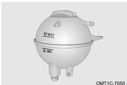
Cuando el motor está frío, el nivel de refrigerante debe estar entre las marcas "MAX" y "MIN". Si el nivel está en la marca "MIN" o por debajo de ella, agregue el refrigerante y diríjase a la estación de servicio autorizada para su inspección y reparación de inmediato.
