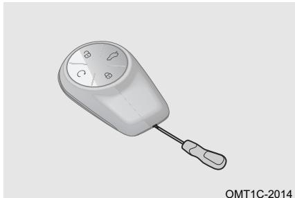
1. Saque la cubierta de la llave usando un destornillador de cabeza plana con la punta pegada;
