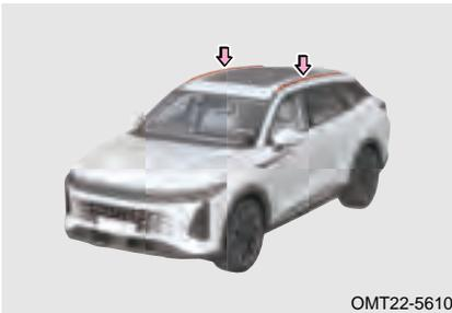
El portaequipajes de techo se utiliza para cargar cargas que puede soportar cargas de 30 kg. El sobrepeso causará daños en el portaequipajes, el techo del cuerpo y otros componentes, los diversos problemas causados por el sobrepeso no están cubiertos por la garantía.
