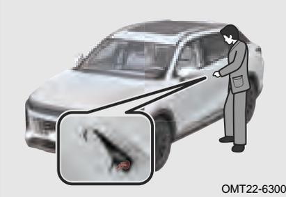
2. Tire de la manija de la puerta e inserte la llave mecánica en el orificio de la llave en la manija de la puerta exterior, y gire en sentido horario para bloquear la puerta del conductor y gire en sentido antihorario para desbloquear la puerta del conductor.
