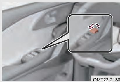
Para el vehículo con apertura electrónica, tire de la manija de apertura de la puerta interior hacia arriba una vez para abrir la puerta mecánicamente cuando la puerta esté en estado de desbloqueo / bloqueo; Para el vehículo sin apertura electrónica, tire de la manija de apertura de la puerta interior hacia arriba dos veces para abrir la puerta mecánicamente (La primera vez es para desbloquear la puerta y la segunda vez es para abrir la puerta).
