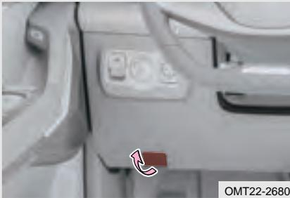
1. Tire de la palanca de liberación del capó y el capó se levantará ligeramente; Tire de él de nuevo y el capó se levanta un poco más;
