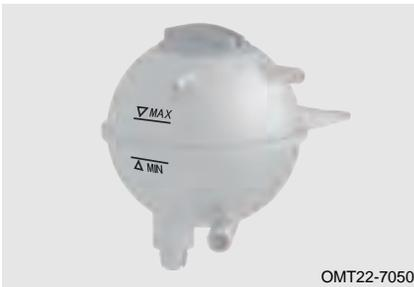
Cuando el motor está frío, el nivel de refrigerante debe estar entre las marcas "MAX" y "MIN". Si el nivel está en la marca "MIN" o por debajo de ella, agregue el refrigerante y diríjase a la estación de servicio autorizada de EXEED para su inspección y reparación de inmediato.
