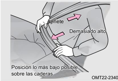
El cinturón de seguridad se bloqueará cuando se extraiga rápidamente, pero no se bloqueará cuando lo saque lentamente. Coloque el cinturón de regazo tan bajo como sea posible en las caderas, no en las cinturas, luego ajústelo a un ajuste ceñido tirando del cinturón de hombros hacia arriba.
