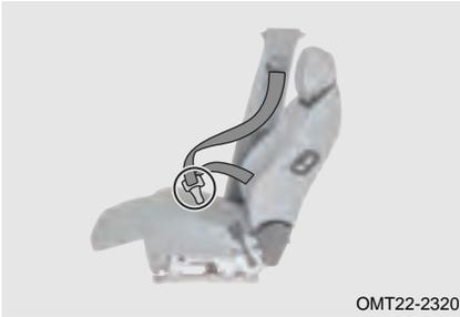
El cinturón de seguridad se debe inspeccionar periódicamente por daños o desgaste. Cualquier cinturón de seguridad estirado (como después de un accidente de tráfico) debe ser inspeccionado de inmediato por la estación de servicio autorizada EXEED o reemplazar los componentes relacionados de acuerdo con sea necesario.
