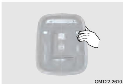
Toque la luz de techo frontal izquierda / derecha, se enciende la luz de techo frontal en el lado correspondiente; Vuelva a tocar la luz de techo frontal izquierda/derecha, la luz de techo delantera en el lado correspondiente se apaga.
