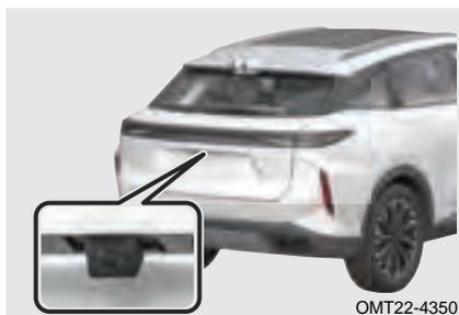
Posición de instalación de la cámara trasera: Parte superior media de la placa de matrícula trasera.
