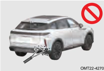
El flujo de agua a alta presión, como pistolas de agua o grandes fuerzas externas, puede dañar los sensores de radar. No apriete ni golpee el sensor de radar, de lo contrario, podría causar funcionamiento anormal.
