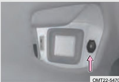
Solo se puede utilizar la toma de corriente cuando el interruptor de arranque y parada del motor se gira al modo ON.
