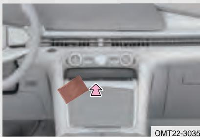
Después de desbloquear el vehículo con la llave de tarjeta NFC, el usuario pisa el pedal del freno en 3 minutos para arrancar el vehículo. Después de 3 minutos, coloque la llave de tarjeta NFC en el área de detección de carga inalámbrica dentro del vehículo y luego se puede arrancar el vehículo.
