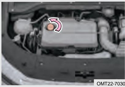
1. Para abrir la tapa del depósito de aceite de motor, gire la tapa en contra del sentido de las agujas del reloj;
