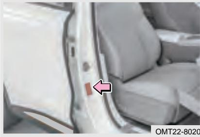
La placa de identificación del vehículo está fijada en el panel exterior de cuarto derecho.
