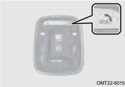
ECALL es un tipo de función de llamada de emergencia. Cuando el vehículo está involucrado en un cierto nivel de impacto (airbag inflado) o cuando el conductor o el pasajero se encuentra en una emergencia y se requiere rescate, la información de emergencia puede ser enviado al centro de servicio operando el botón manualmente, entonces el centro rastreará la ubicación del vehículo y ofrecerá rescate inmediatamente de acuerdo con la información recibida.
