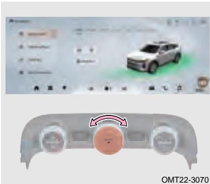
Gire la perilla del modo de conducción o ajuste el modo de conducción en la unidad principal, el icono del modo correspondiente en el cuadro de instrumentos aparecerá acompañado de un recordatorio de voz para indicarle que el modo de conducción se ha cambiado correctamente.
