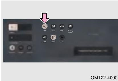
Gire el interruptor de ARRANQUE Y PARADA DEL MOTOR al modo ON, presione el interruptor de arranque y parada "⏻", el sistema de arranque y parada se apaga; presione el interruptor de arranque y parada nuevamente, el sistema de arranque y parada se enciende.
