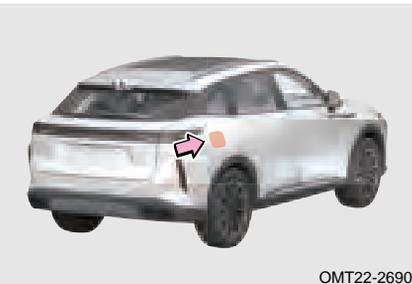
1. Después de desfortificar el vehículo, empuje la puerta de llenado de combustible y se abrirá;
