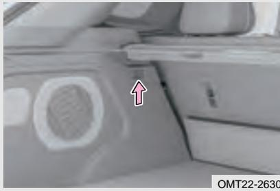
Cuando se abre la portón trasero, la luz del maletero se enciende automáticamente. Cuando la portón trasero está cerrada, la luz del maletero se apagará inmediatamente.
