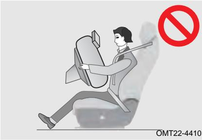
Mantenga siempre limpia la tura de inflado de airbag. Está prohibido colocar cualquier cosa (teléfono, etc.) entre el ocupante y el airbag. Está prohibido fijar o colocar cualquier objeto sobre o cerca de la cubierta de airbag. Si hay un objeto entre el ocupante y la bolsa de aire, es posible que la bolsa de aire no se despliegue de acuerdo con la ruta de diseño, o la bolsa de aire puede empujar objetos al cuerpo del ocupante, causando lesiones graves o incluso la muerte.
