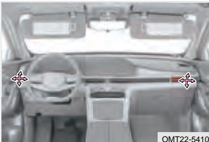
Mueva la palanca de ajuste de salida del lado izquierdo/derecho hacia arriba y hacia abajo, hacia la izquierda y hacia la derecha con la mano para ajustar la dirección del flujo de aire.
