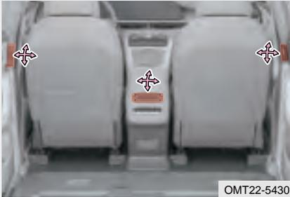
Mueva la palanca de ajuste de salida de la caja del reposabrazos hacia arriba y hacia abajo, hacia la izquierda y hacia la derecha con la mano para ajustar la dirección del flujo de aire.
