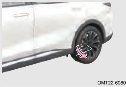
Antes de levantar el vehículo, afloje los tornillos de la rueda que va a reemplazar con una llave de tornillos de la rueda girándolos en sentido antihorario. Coloque la llave del tornillo de rueda en el tornillo de rueda con el mango hacia la izquierda como se muestra en la ilustración. Sostenga el extremo final del mango y presione hacia abajo.
