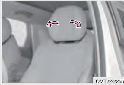
Puede ajustar el ángulo de ambas alas del reposacabezas para el reposacabezas de aviación (como se muestra en la figura), y el estado de despliegue es mismo que el reposacabezas ordinario; El reposacabezas de aviación mejora la comodidad del soporte lateral del reposacabezas, aliviando eficazmente la incomodidad causada por la turbulencia, el impacto y la conducción de larga distancia durante la conducción.
