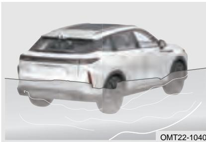
El vehículo se podría ver gravemente dañado al conducir en una carretera que se ha inundado después de una lluvia intensa. Si es inevitable conducir sobre agua, revise la profundidad de agua y conduzca lentamente y cuidadosamente.
