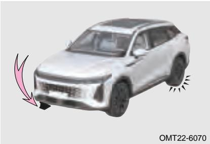
Cuando levante el vehículo, debe colocar un bloque debajo del neumático diagonalmente opuesto al neumático desinflado para evitar que las ruedas rueden.
