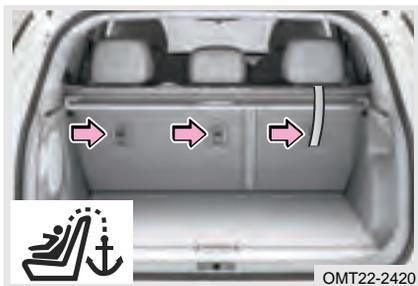
4. Tire de las correas del sistema de retención infantil y fíjelas con el punto de fijación superior (TOP TETHER) para el sistema de retención infantil orientado hacia adelante (como se muestra en la ilustración).
