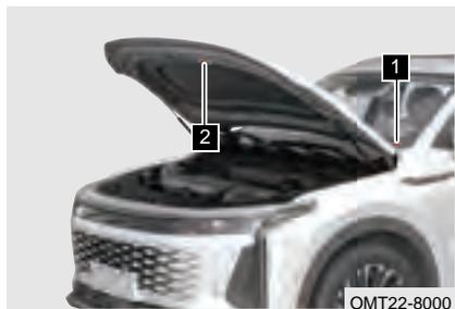
**1** El VIN se encuentra en la parte superior izquierda del panel de instrumentos del lado del conductor, y puede verse desde el exterior a través del parabrisas.
