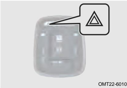
Presione el interruptor de la luz de peligro para encender y presiónelo nuevamente para apagar.
