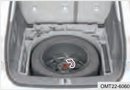
Abra el portón trasero, levante la alfombra del maletero y saque la caja de almacenamiento y la bolsa de herramientas. Gire el perno de fijación del neumático de repuesto en sentido contrario para retirarlo y luego extraiga el neumático de repuesto.
