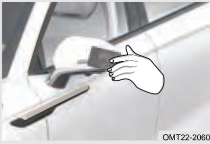
Acerque la llave de tarjeta NFC a la marca NFC del espejo retrovisor exterior izquierdo. Después de unos segundos, el vehículo se puede desbloquear / bloquear. La manija oculta de la puerta se extenderá automáticamente después de desbloquearse con éxito o se retraerá automáticamente después de bloquear con éxito para desbloquear / bloquear la puerta.
