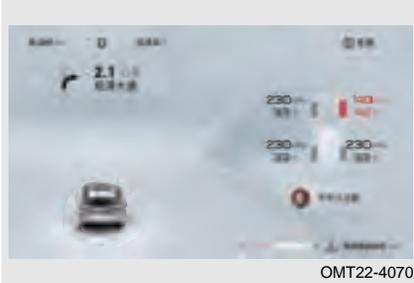
Cuando la presión de inflado de neumáticos es inferior a 175 kPa, y el vehículo continúa conduciendo a una velocidad mayor de 30 km/h, el sistema enviará advertencia de baja presión en 5 minutos.
