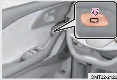
Si el interruptor de desbloqueo de la puerta se presiona mientras la puerta está en estado de desbloqueo, la puerta se abre automáticamente.
