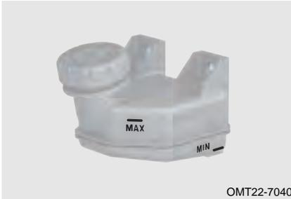
El nivel de líquido de frenos debería encontrarse entre las marcas "MIN" y "MAX". Si el nivel es igual o inferior a la marca "MIN", agregue el líquido de frenos vaya a la estación de servicio autorizada de EXEED para su inspección y reparación de inmediato.
