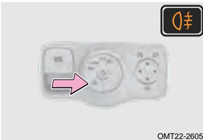
Gire el interruptor de ARRANQUE Y PARADA DEL MOTOR al modo ON, gire el interruptor de combinación de faros a la posición "D" o "AUTO", presione el interruptor de la luz antiniebla trasera "R", se enciende la luz antiniebla trasera; Presione el interruptor nuevamente, la luz antiniebla trasera se apaga.
