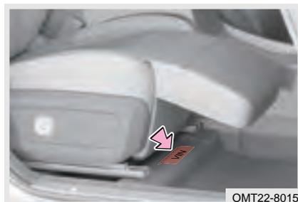
La etiqueta del Número de Identificación del Vehículo (VIN) está ubicada en el travesaño del asiento delantero derecho, como se muestra en la ilustración. (Por diferencias regionales, la ubicación del código VIN estará sujeta al vehículo real. )
