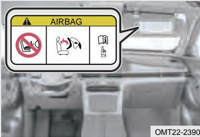
Esta pegatina está unida a la parte delantera y trasera del parasol del pasajero delantero y se utiliza para recordarle que el vehículo está equipado con airbags frontales. Se observen las siguientes precauciones:
