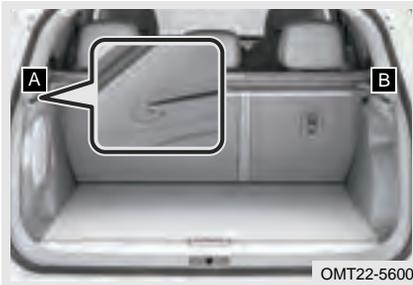
Tire de la cortina de equipaje hacia las ranuras del punto A y el punto B para sujetarla, y confirme que si está sujetado adecuadamente.
