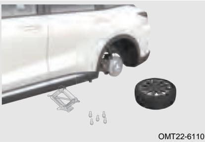
Quite los 5 pernos de rueda en sentido antihorario y quite las ruedas usando la llave de perno de rueda. Coloque la rueda en el suelo con el cubo hacia arriba, evite rayar la superficie del cubo.
